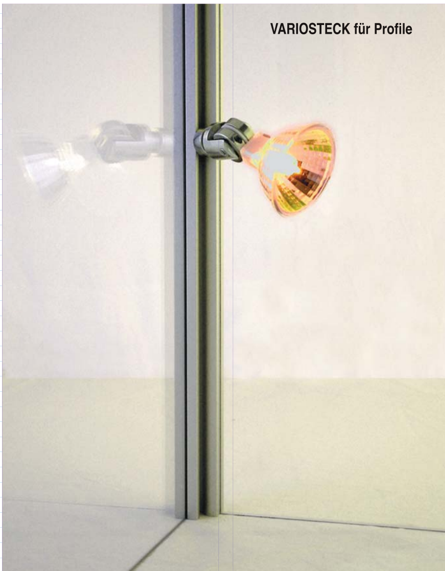
VARIOSTECK-Fassung verschraubt für Lampenfassung SF 10 für maximale Sicherheit in Vitrinen sichtbare Höhe 8 mm, Innenleiter verkabelt, Aussenleiter über Profil
