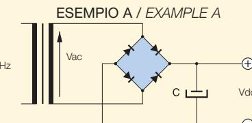
La tensione di alimentazione deve essere adeguata alle caratteristiche dei dispositivi usati. Usare sempre trasformatori con tensione di secondario Vca inferiore alla tensione continua desiderata Vcc. La tensione Vca di secondario da utilizzare si ricava così:
