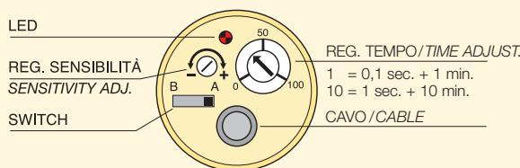
\* Identificare il N° 100 della scala del trimmer di regolazione tempo con il fondo scala della gamma di temporizzazione (1 min. oppure 10 min.).
