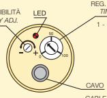
\*Identificare il n° 100 della scala del trimmer di regolazione tempo con il fondo scala della gamma di temporizzazione.
