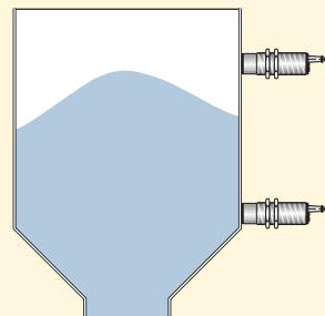
CONTROLLO DI LIVELLO IN SERBATOI METALLICI
